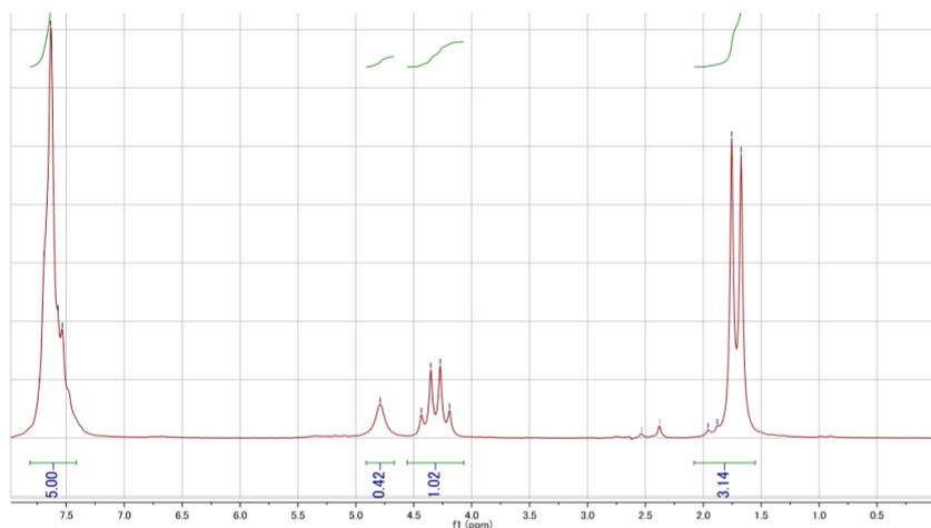
上のチャートは1から2ppmにピークが観測されます。化学シフト値よりメチル基及びアミノ基のプロトンであることが推測されます。一方下のチャートでは重水中で測定しました。すると上図で観測できる1.88ppmのピークが消失しています。
